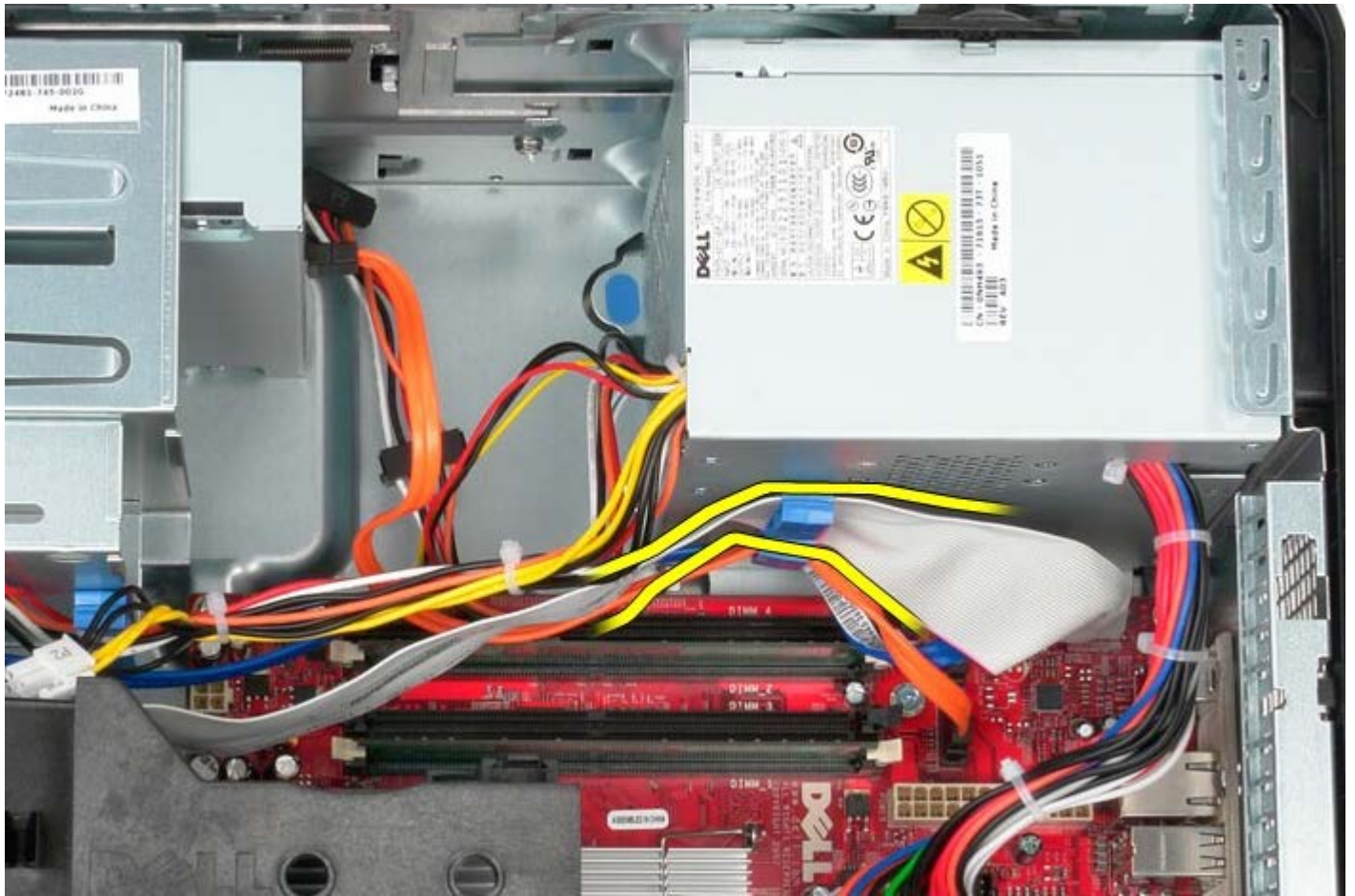
1 11 電源ユニットの底にあるケーブル配線にあるデータケーブルを外します。
