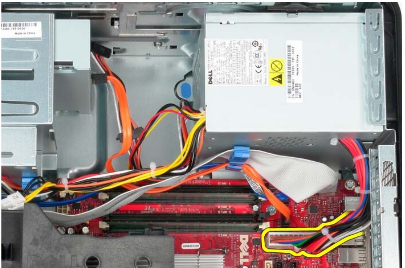
1 11 電源ユニットの底にあるケーブル配線から IO パネルデータケーブルを外します。
