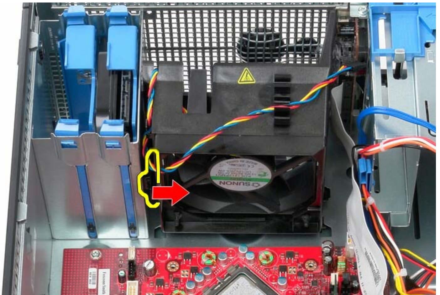
1 11 プロセッサファンをコンピュータの背面に向かってスライドさせます。
